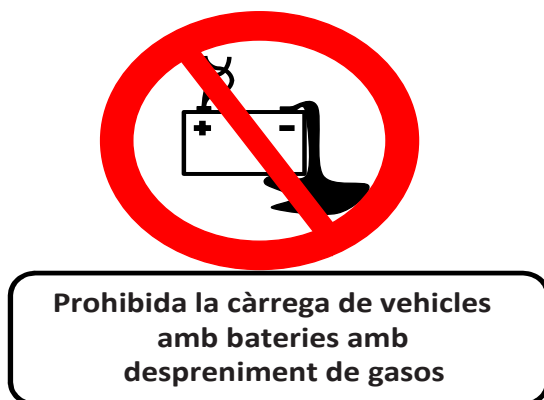
Figura 4: Senyalització obligatòria en instal·lacions interiors
