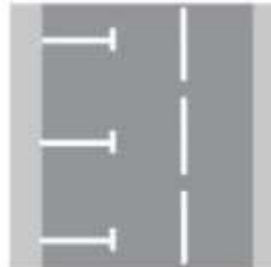
Línies de vora i estacionament
